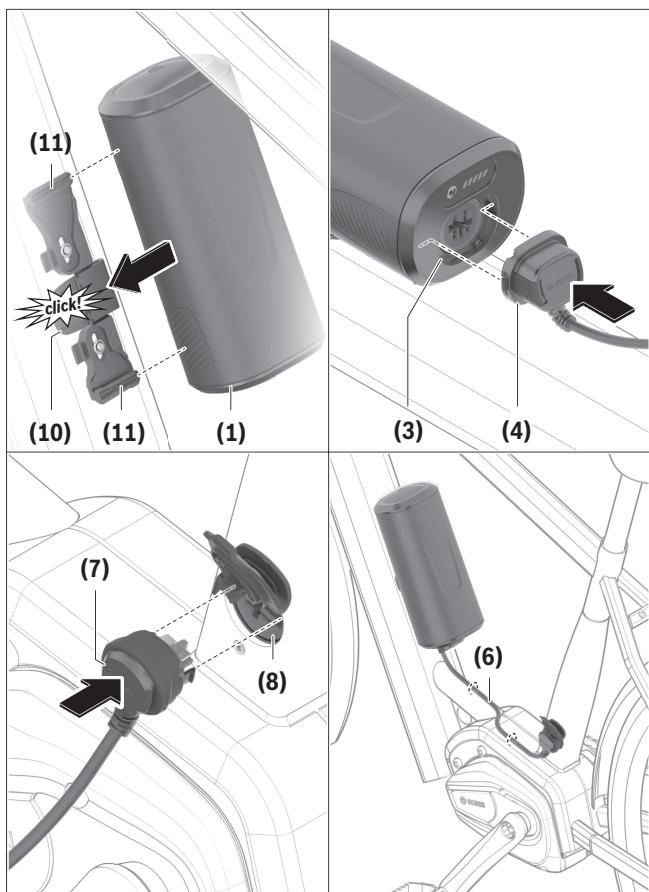
Para **insertar** la batería (1), colóquela con las ranuras guía (12) contra los carriles guía (11). Asegúrese de que la batería esté correctamente alineada e insertada en ambos carriles guía. Introduzca la batería (1) en el soporte (9) hasta que encaje de forma audible.
