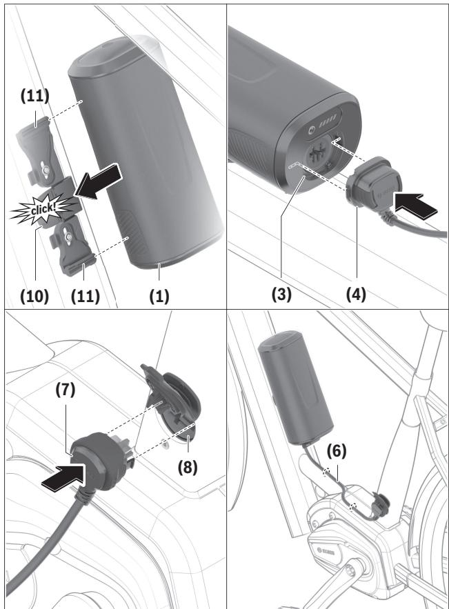
Pour **mettre en place** la batterie (1), positionnez ses rainures de guidage (12) au niveau des rails de guidage (11). Veillez à orienter la batterie dans le bon sens et à l'insérer dans les deux rails de guidage. Faites coulisser la batterie (1) dans le support (9) jusqu'à ce qu'elle s'enclenche de manière audible. Raccordez le connecteur (4) du câble à la prise de raccordement (3). Veillez à l'orientation correcte du connecteur (4).
